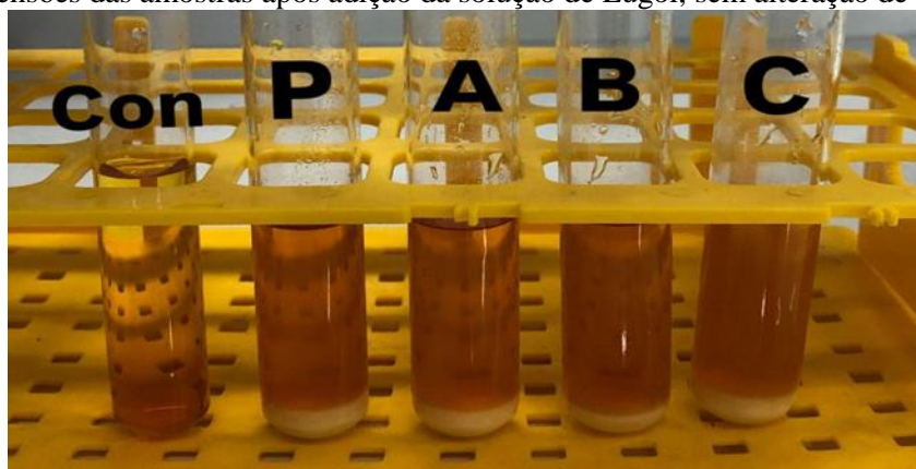
Figura 1- Suspensões das amostras após adição da solução de Lugol, sem alteração de coloração.
